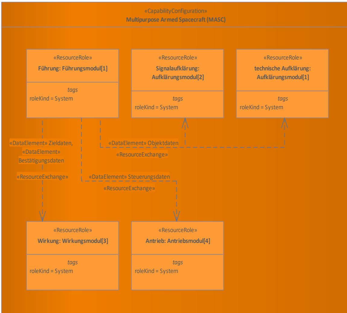
Das Beispiel zeigt die Struktur des Gesamtsystems "Multipurpose Armed Spacecraft (MASC)". Zusätzlich dazu hat das Raumschiff diverse interne Datenaustauschbeziehungen zwischen den Bestandteilen (Modulen) des Raumschiffes. U.a. sendet das Führungsmodul "Führung" das Datenelement "Zieldaten" an das Modul Wirkungsmodul "Wirkung".
