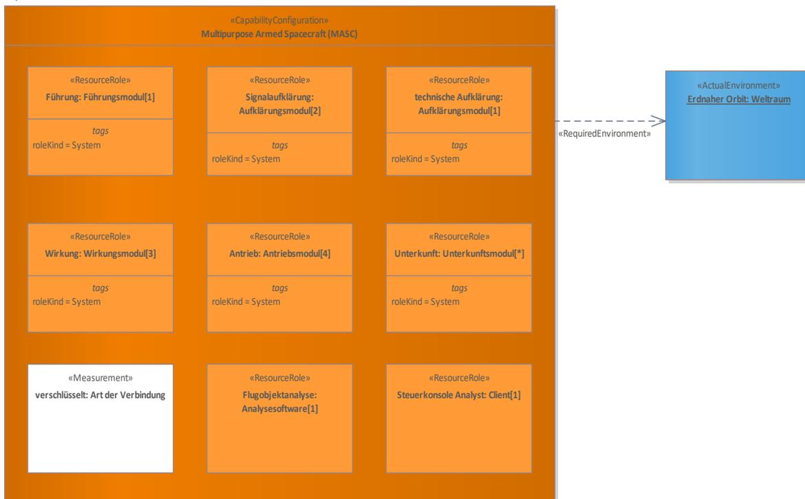
Das Beispiel zeigt die Struktur des Gesamtsystems "Multipurpose Armed Spacecraft (MASC)". Dieses besteht aus einem "Führungsmodul", zwei verschiedenen "Aufklärungsmodulen" (2x "Signalaufklärung", 1x "technische Aufklärung"), drei "Wirkungsmodulen", vier "Antriebsmodulen" und einer unbestimmten Anzahl an "Unterkunftsmodulen". Zudem verfügt das System über den Parameter "Art der Verbindung". Das "Multipurpose Armed Spacecraft (MASC)" ist für den Einsatz im "erdnahen Orbit" konzipiert.
