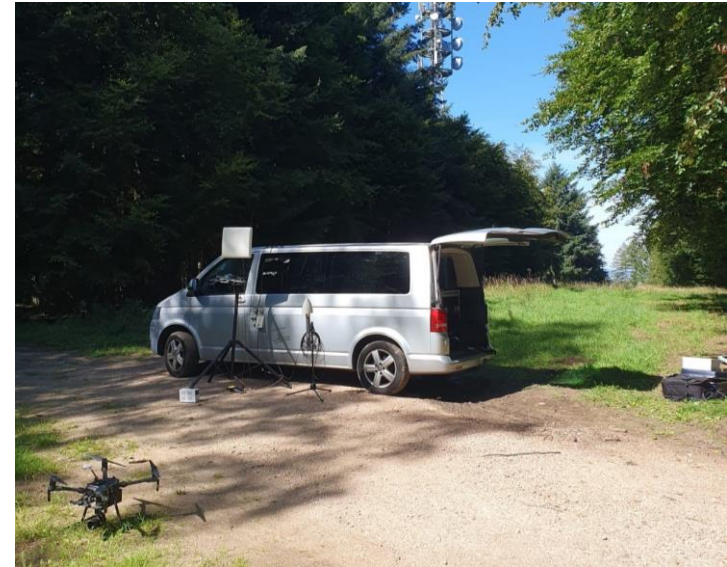
Experimentelles Passivradar zur Drohnenortung, das im Rahmen des Projekts 450detect von BDEW, 450connect und Fraunhofer FKIE entwickelt wurde. Ziel des Projekts ist es, perspektivisch Drone-Detection-as-a-Service anzubieten. ©Fraunhofer FKIE.
