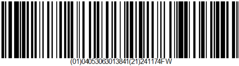
Bild A.1: Beispielhafter GS1-128 Strichcode mit GTIN und Seriennummer
