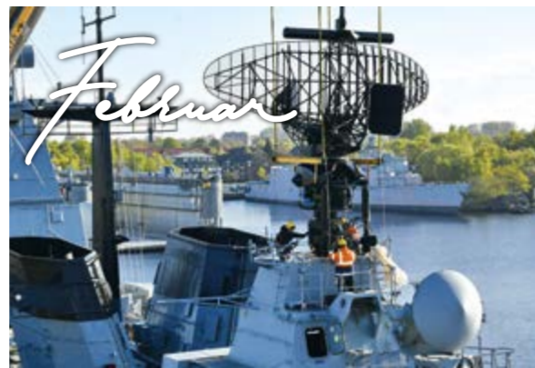
Februar Instandsetzungsarbeiten an der Radaranlage der Fregatte „Bayern“ (Klasse F123) in einer Werft des Marinearsenals (MARs).
