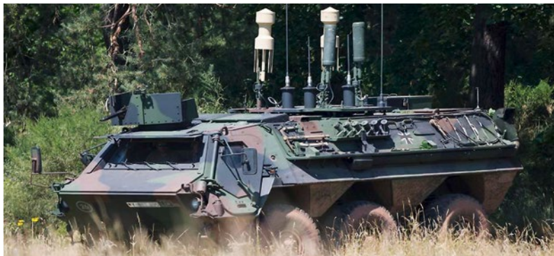
Auf einem Transportpanzer Fuchs aufgebautes, mobil einsetzbares und geschütztes Störsystem, das gegen per Funk fernausgelöste Sprengsätze wirkt
